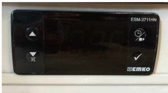
Joonis 3. Temperatuuri kontrolleri väljalülitatud olek
