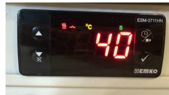
Joonis 5. Parameetrite muutmise režiim, mida näitab ka üleval ribal asetsev „S“ täht.
