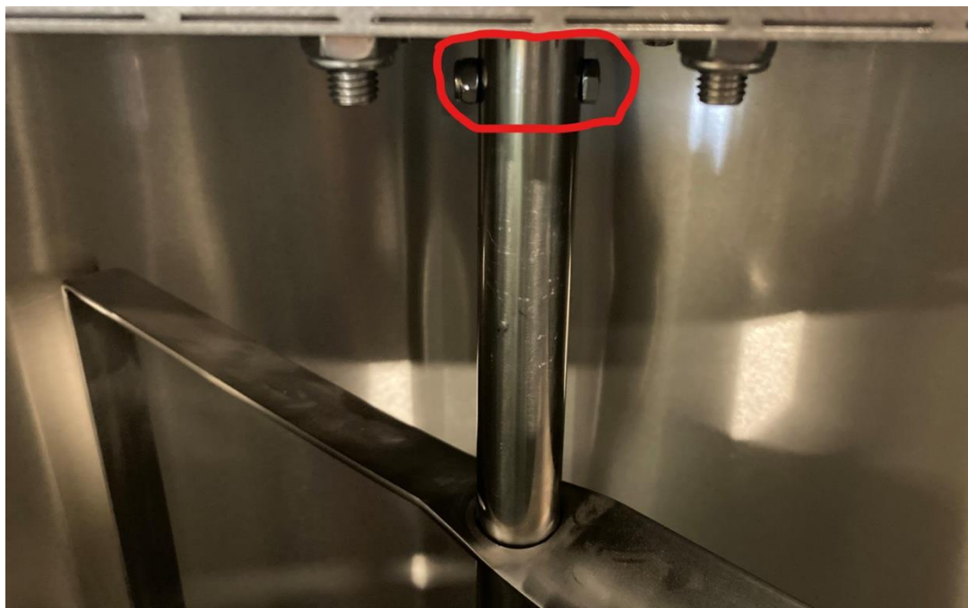
Joonis 6. Visplivõlli ülekoormus kaitse polt M6x30 roostevaba polt ja M6 mutter.
