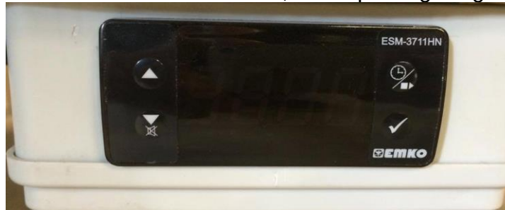
Joonis 3. Temperatuuri kontrolleri väljalülitatult
