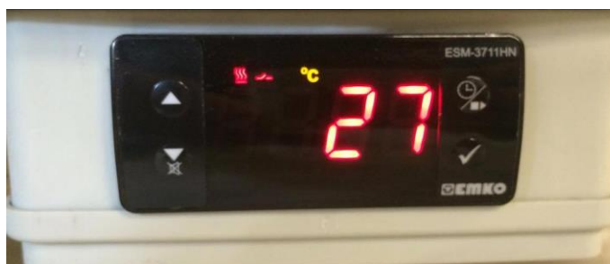
Joonis 4. Temperatuuri kontrolleri sisselülitatult
