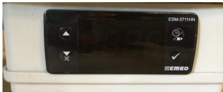
Kui temperatuuri kontrolleri ei ole sisselülitatud, siis ei põle ega vilgu ühtegi tulukest: Joonis 3. Temperatuuri kontrolleri väljalülitatult
