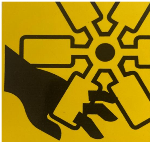
Pöörlevad osad / vahele jäämise oht
