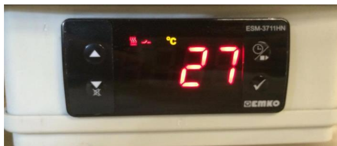
Joonis 4. Temperatuuri kontrolleri sisselülitatult
