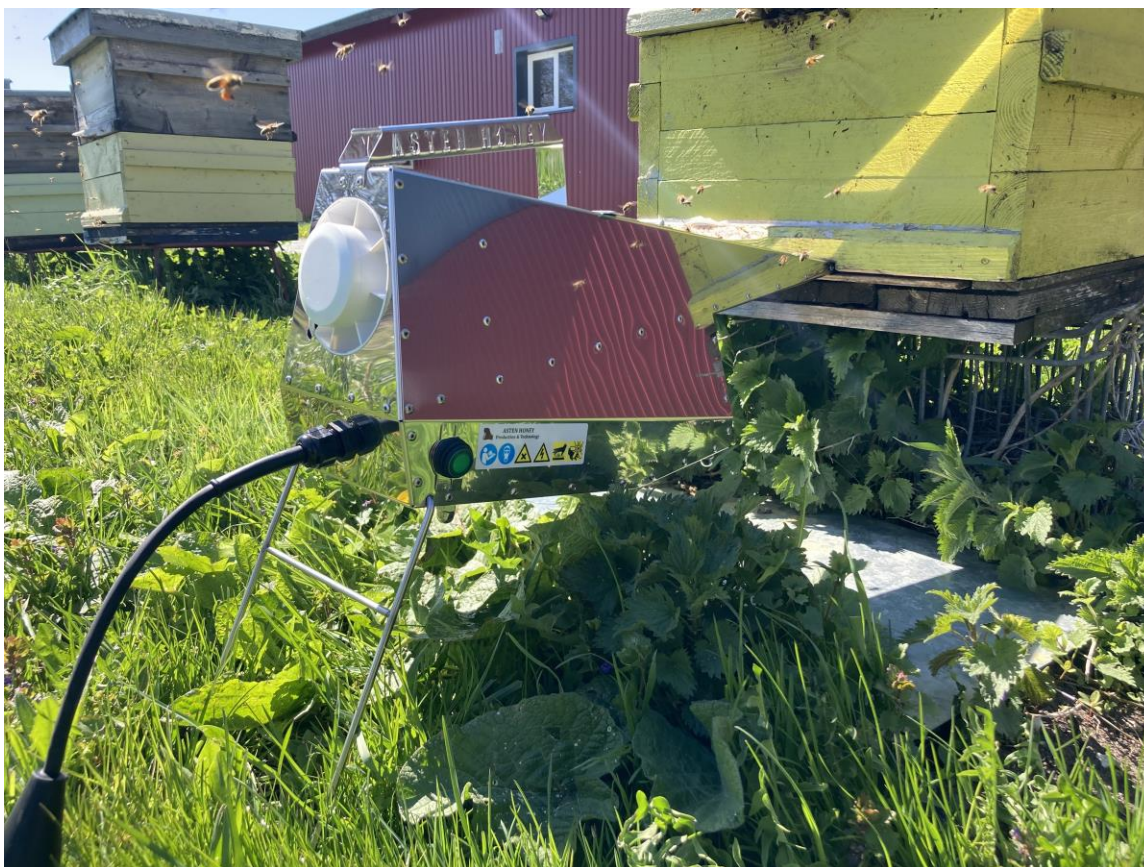
Joonis 1. Jalgade asend ja masina paigutus lennuava suhtes.
