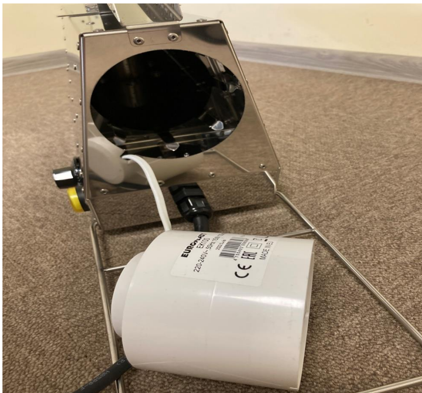
Joonis 1. Eemaldatud ventilaator
