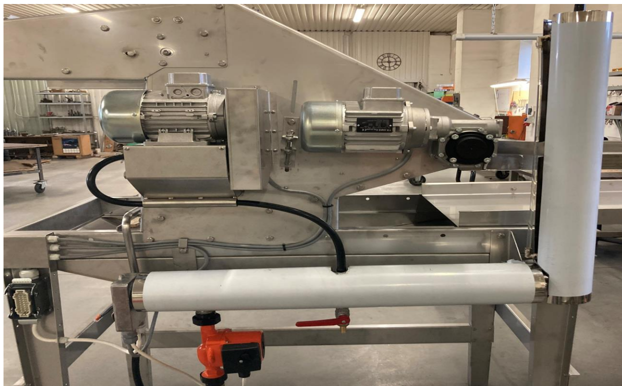
Nugade soojendussüsteem üldvaade
